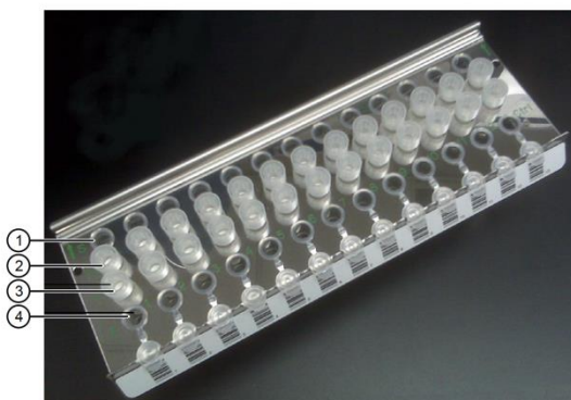
Рис. 2 Расположение наконечников, держателей наконечников, пробирок для лизатов и пробирок для элюции в штативе
